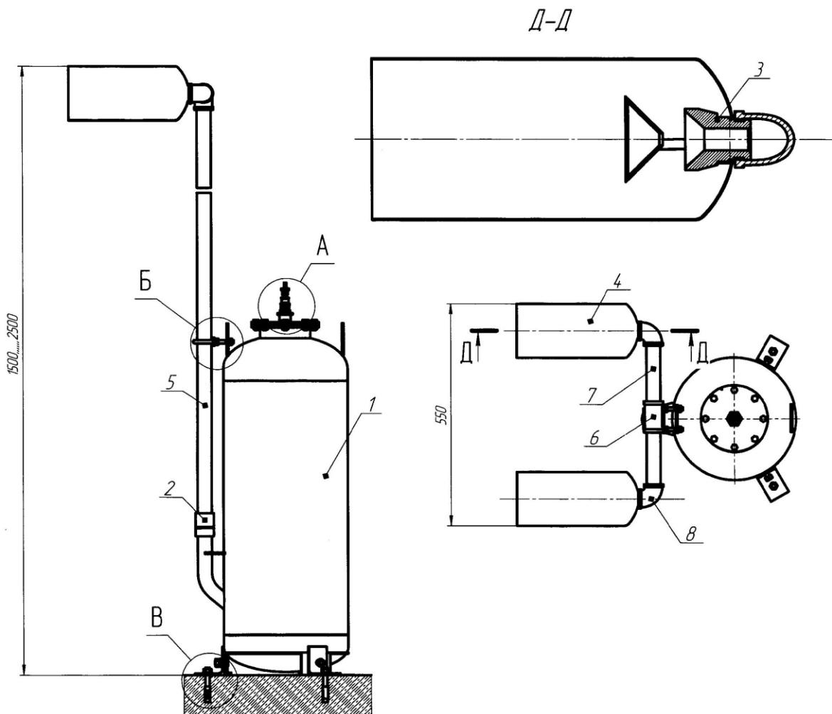
1- модуль ММП «Панцирь-50»; 2- клапан; 3- насадок-распылитель ; 4- насадок-успокоитель; 5 - стояк трубы 25 ГОСТ 3262-75; 6- тройник 25 ГОСТ 8948-75 ; 7- сгон трубы 25 ГОСТ 8969-75; 8- угольник 25 ГОСТ 8946-75; .
