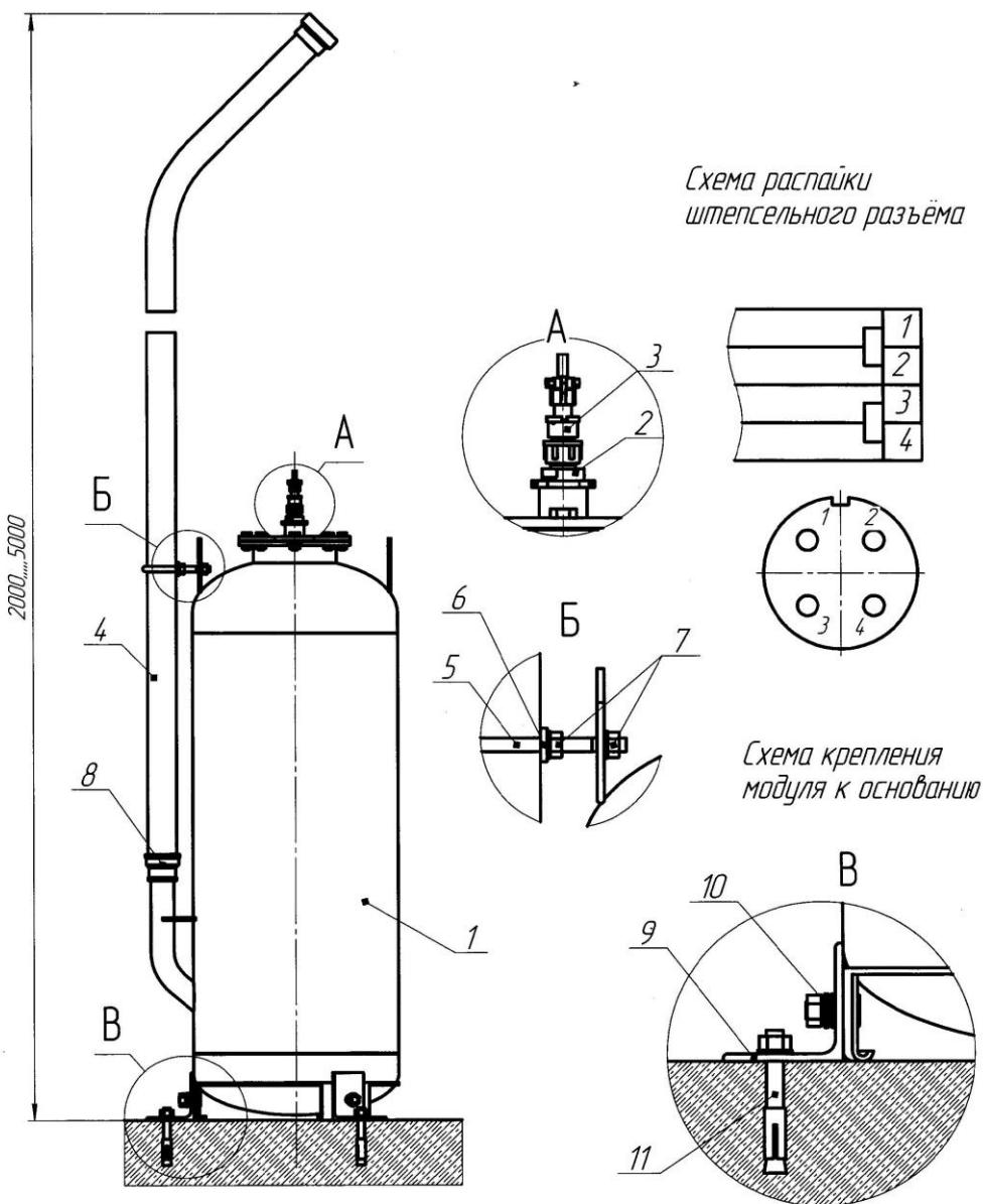
1- модуль «Панцирь-50»; 2 - электровоспламенительное устройство ЭВУ-2; 3-розетка ШР2РМ14КПН4Г1В1; 4- направляющий трубопровод в сборе насадком и мембраной; 5- скоба; 6- планка; 7- гайка М8 ГОСТ 5915-70; 8- муфта 25×30 ГОСТ 8957-75 ; 9 –уголок; 10-заземляющий зажим 3Б-С-8×25 ГОСТ 21130-75; 11- клиновой анкер S-KA 10x50 (Sormat).
