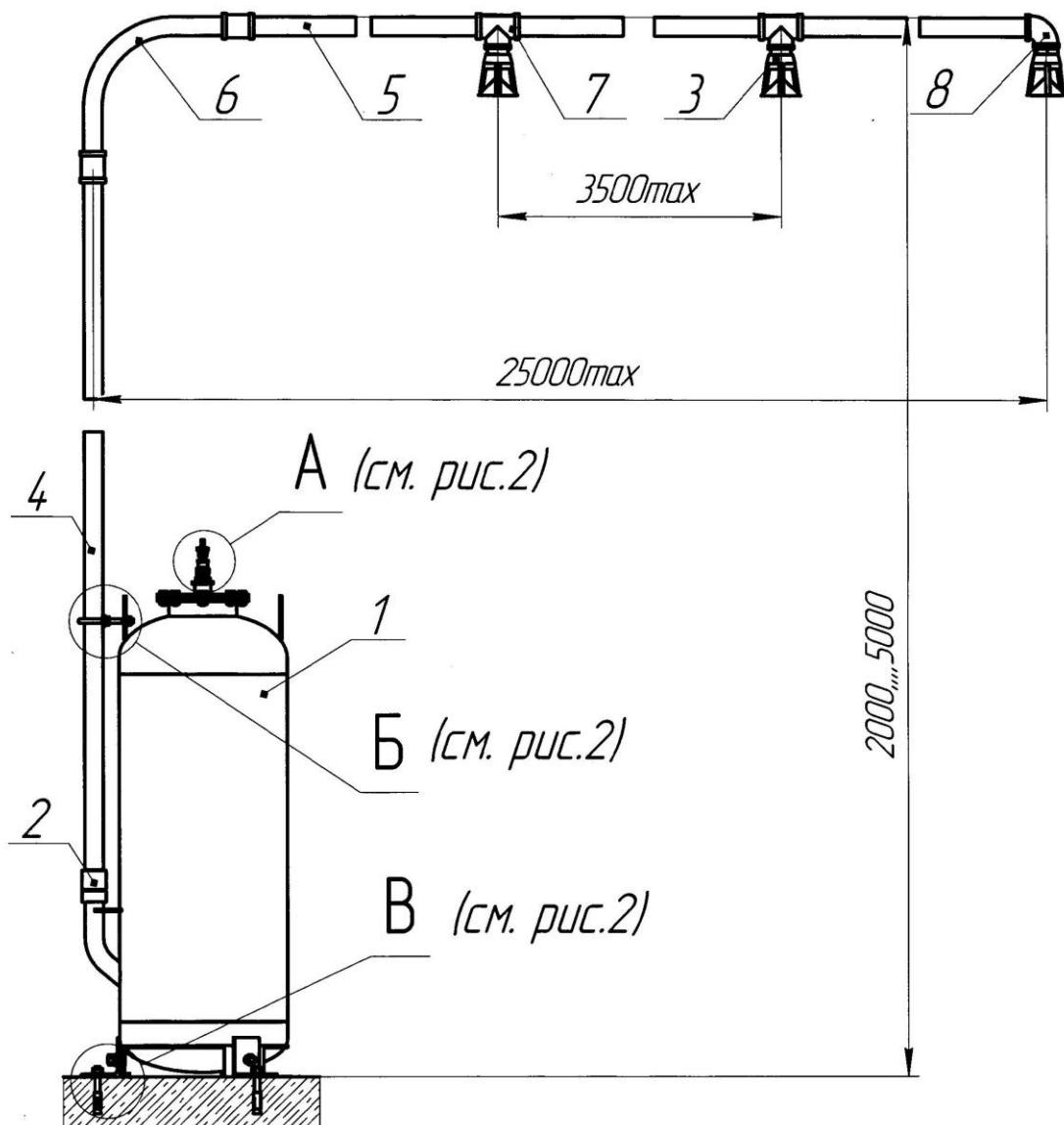
1- модуль ММП «Панцирь-50»; 2- клапан; 3- насадок-распылитель (не более 4 шт.) ; 4- стояк трубы 25 ГОСТ 3262-75; 5- сгон трубы 25 ГОСТ 8969-75 ; 6- труба 25 ГОСТ ; 7- тройник 25 ГОСТ 8948-75; 8- угольник 25 ГОСТ 8946-75
