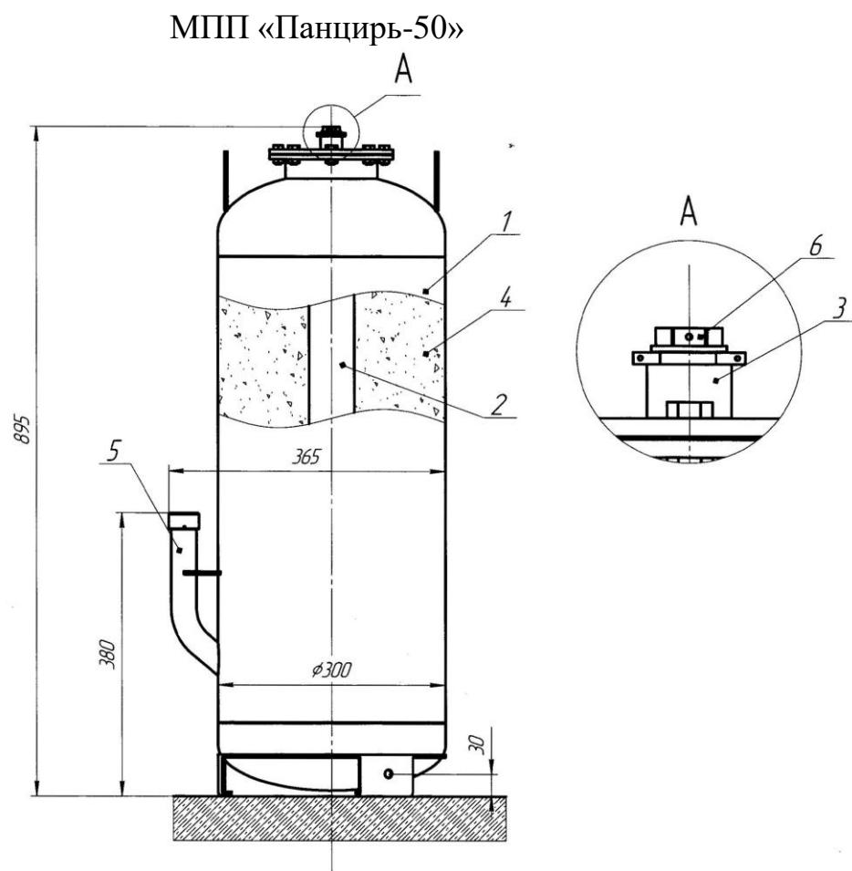
1 - корпус МПП «Панцирь -50»; 2 - газогенератор; 3 - узел запуска;
